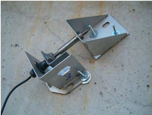
Ubicazione del fessurimetro elettrico a cavallo della frattura presente in prossimità dell'appoggio
