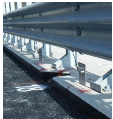
Fig. 4-5 – Elettrolivelle lungo un lato del viadotto durante le misure
