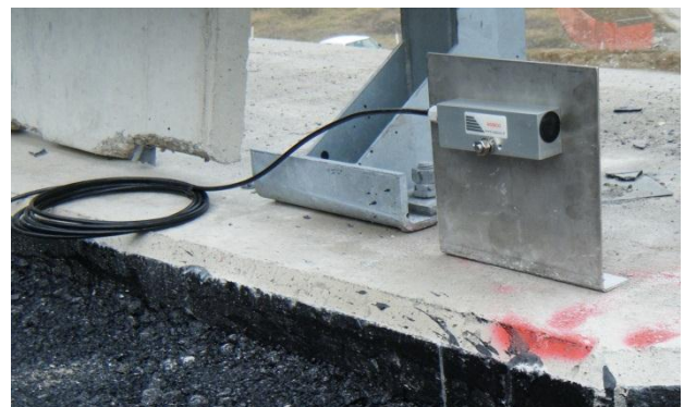
Fig. 4-5 – Elettrolivelle lungo un lato del viadotto durante le misure
